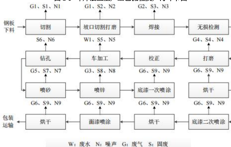
图 2-4 加强板法兰生产工艺流程及产污环节图
